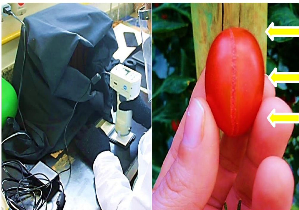
Figura 1: Calibração do colorímetro e as regiões de medições do tomate cereja sweet heaven tipo grape .
